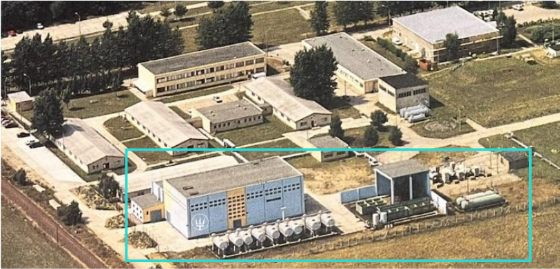
Abb. 1: Luftaufnahme der Anlage zur direkten Rohstoffextraktion (türkis markierter Bereich) am Betriebsstandort Steinitz bei Salzwedel. Das leicht modifizierte Foto stammt aus den frühen 1990er Jahren. Die Tanks vor dem Gebäude enthielten die für den Prozess erforderlichen organischen Lösungsmittel (Wenke et al. 2025).
