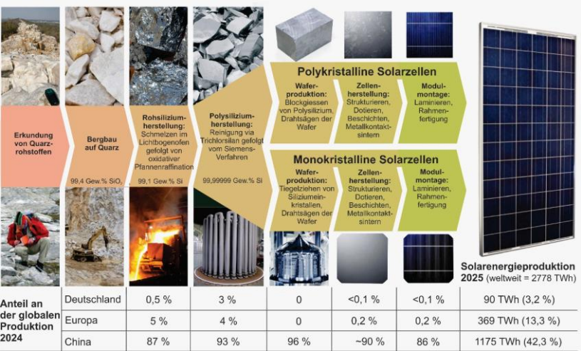
Abb. 1: Wertschöpfungskette des Siliziums in der Solarmodulproduktion. Nach der Polysiliziumproduktion verzweigt sich die Kette in die Herstellung polykristalliner Solarzellen (14 % der Produktion im Jahr 2025) und monokristalliner Solarzellen (86 % der Produktion im Jahr 2025). Die prozentualen Anteile an den einzelnen Stufen der Wertschöpfungskette für 2024 stammen aus der International Energy Agency (2025). Die Zahlen zur Solarstromerzeugung 2025 (in TWh = Terawattstunde) für Europa und Deutschland wurden von Ember Energy (2026) übernommen, die weltweiten Daten von der International Renewable Energy Agency (2026).
