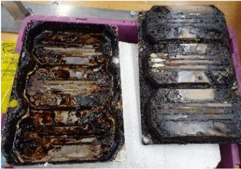
Abb. 5: Stark mit Klebstoff kontaminierte Magnete aus Windkraftanlagen (im Stahlgehäuse)
