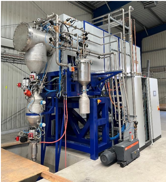
Abb. 7: HPMS-Reaktor im kommerziellen Maßstab bei HyProMag GmbH, Deutschland
