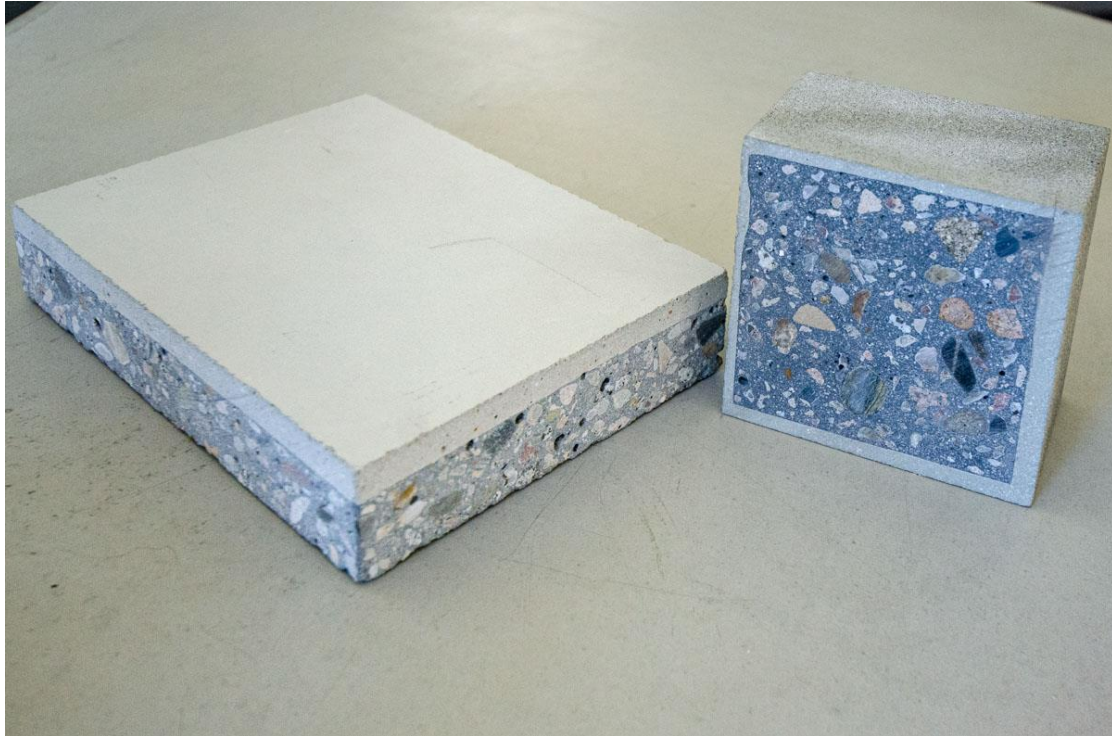
Abb. 6: Erste Prototypen mit ecoLocked Carbonbeton mit gespritzter Außenschicht. ©Beton- und Naturstein Babelsberg GmbH.
