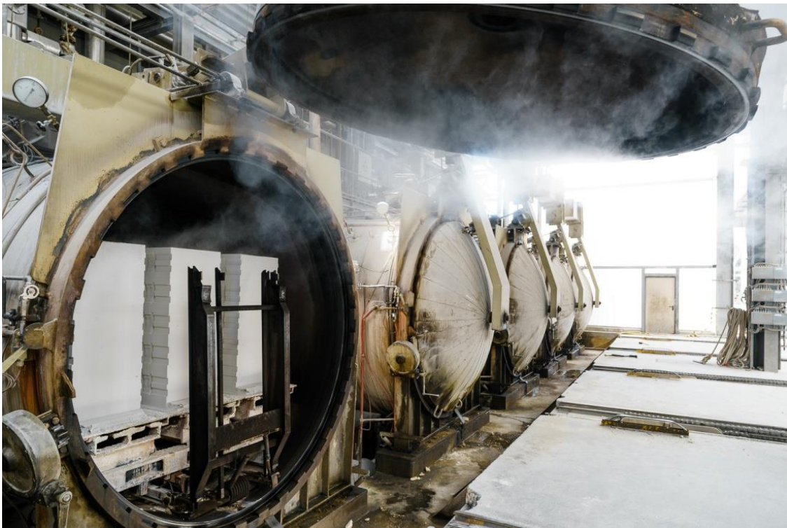
Abb. 9: Porenbetonsteine nach der Härtung im geöffneten Autoklaven (Quelle: Baustoffwerke Havelland © Andreas Herz).
