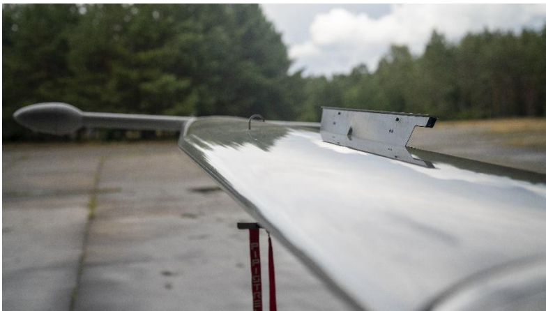
Abb. 3: Ausgefahrene Störklappen an der Tragflächenoberseite.
