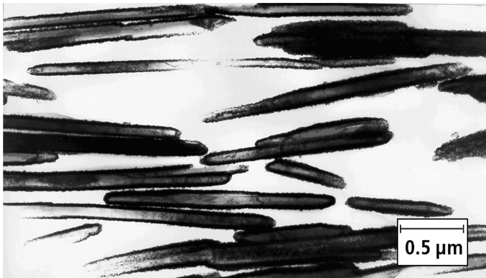
Abbildung 6: Transmissionselektronenmikroskopische Aufnahme eines Lackfilms (Querschnitt), der Partikel eines plättchenförmigen leitfähigen Pigments (Glimmer beschichtet mit (\text{Sn,Sb})\text{O}_2 ) enthält. Die Konzentration an Pigmentteilchen ist so hoch, dass durch die Berührung der Partikel ein Leitfähigkeitspfad durch den Lackfilm gebildet wird (Quelle: Merck KGaA).
