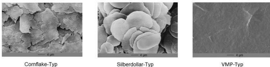
Abbildung 5: Rasterelektronenmikroskopische Aufnahmen der drei für Effektpigmente genutzten Aluminium-Pigmenttypen (Quelle: Carl Schlenk AG).
