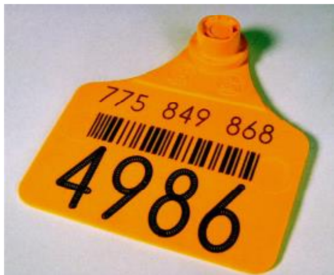
Abbildung 7: Dunkle Lasermarkierung eines Kunststoffes, der ein lasermarkierbares Pigment vom Typ (\text{Sn,Sb})\text{O}_2 /Glimmer enthält (Nd:YAG-Laser).
