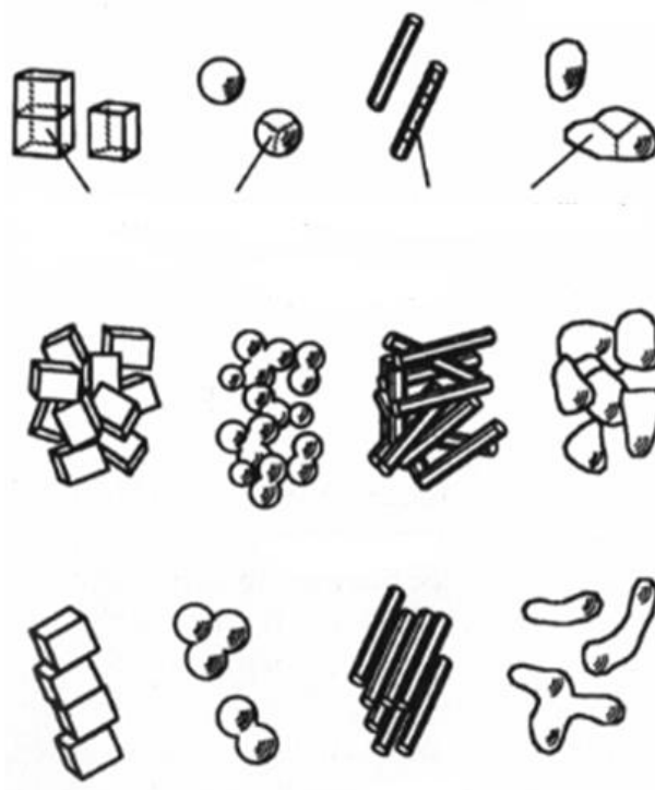
Abbildung 3: Primärteilchen, Agglomerate und Aggregate.
