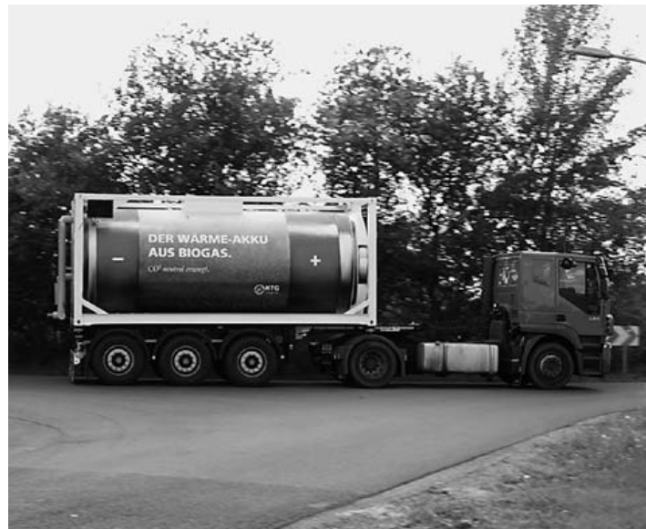
Abbildung 3: Mobiler transformativer Wärmespeicher (Latentwärmespeicher) der KTG Energie AG, Niederlassung Oranienburg zur Nutzung von Abwärme von Biogasanlagen für Heizzwecke. Hersteller ist die LaTherm Energie AG in Dortmund (jetzt Oranienburg). Als Speichermedium werden circa 17 Kubikmeter Natriumacetat-Trihydrat eingesetzt. Damit lassen sich bis zu 2,5 MWh Wärme speichern. Die Aufladedauer eines solchen Speichers beträgt 6,5 Stunden, die Entladedauer bis zu 15 Stunden.
