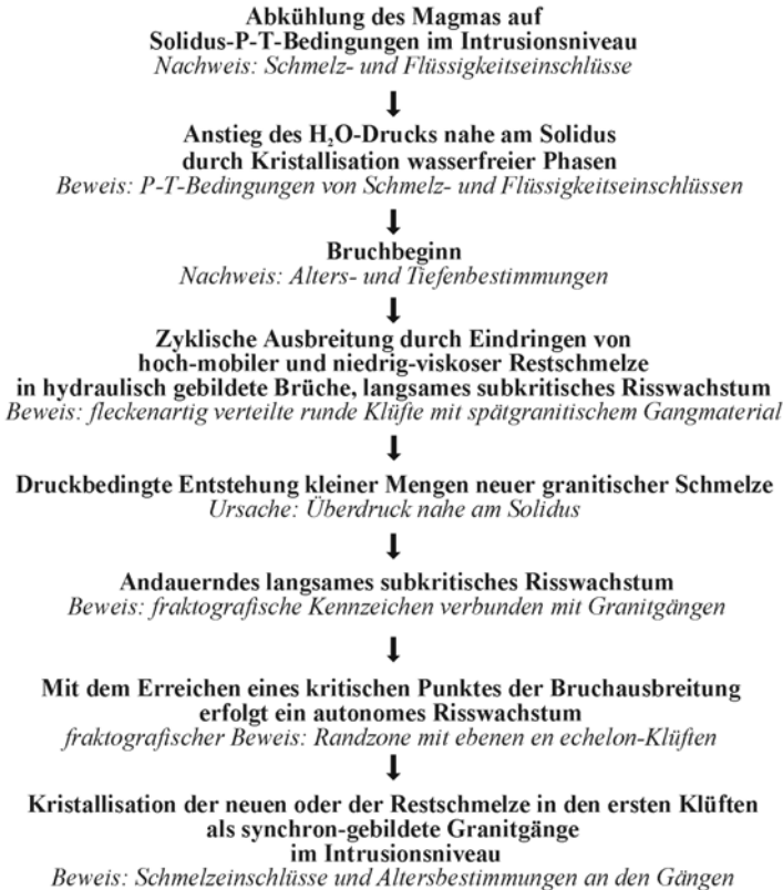
Abb. 8: Abfolge von Vorgängen in einer kristallisierenden granitischen Schmelze, die zu langsam sich ausbreitenden hydraulisch induzierten Klüften führt. Diese erste Ribbildung ist genetisch verbunden mit dem Eindringen von hochmobiler Restschmelze geringer Viskosität in den Rib-Initialpunkt.
