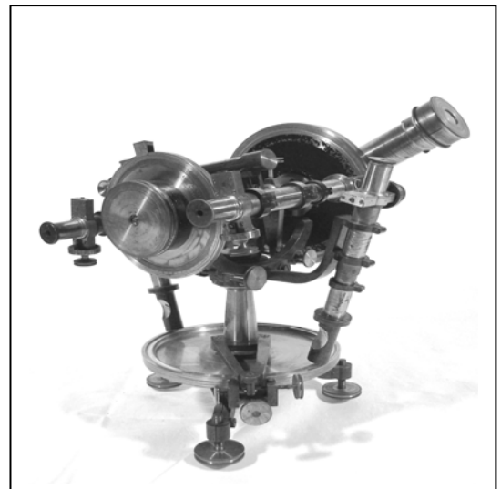
Universalinstrument der Berliner Firma Pistor & Martins, Berlin um 1850, zur präzisen Bestimmung der Koordinaten von Himmels- körpern. S. dazu die Beiträge zum Internationalen Jahr der Astronomie und zur Ausstellung „Astronomisch-mechanische Werkstätten in Berlin und Brandenburg“ S.16 und 19. Foto: Hamel
