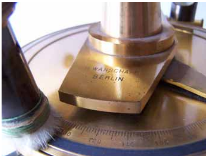
Bild 11: Dass., Herstellersignatur mit Azimutkreis und Objektivende eines Ablesemikroskops mit Reinigungsring
