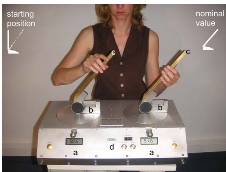
Abbildung 4: Apparatur (Haptimeter) zur Durchführung des Winkel-Paradigma. Elektronischer Winkelmesser (b) und Anzeige (a), Winkelschenkel (c), manuelle digitale Zeitmessung (d). Die Aufgabe der Probanden besteht in der Reproduktion der vorgegebenen Winkelposition ohne visuelle Informationen.
